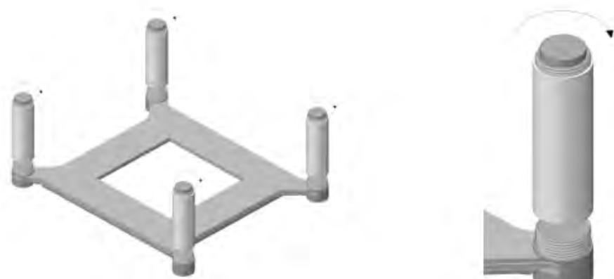
Upper Shelfを慎重に4本の支柱に水平に乗せてUpper Shelf下部のリングを時計方向に回して締め付けて下さい。その時に4本のリングを均等に締め付けて下さい。
